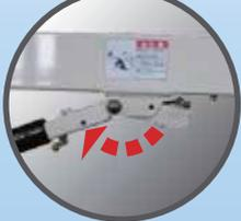
点検・整備時にロックすれば、ブームが固定され安全に作業可能。
