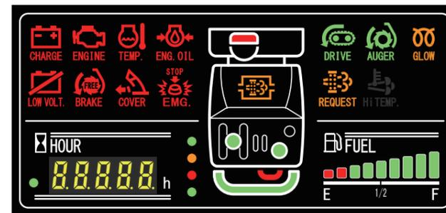
LEDパネルを搭載。クラッチの「入」「切」や、ブロワブレーキなどの安全装置の動作状況や機体の状態がひと目で分かります。
