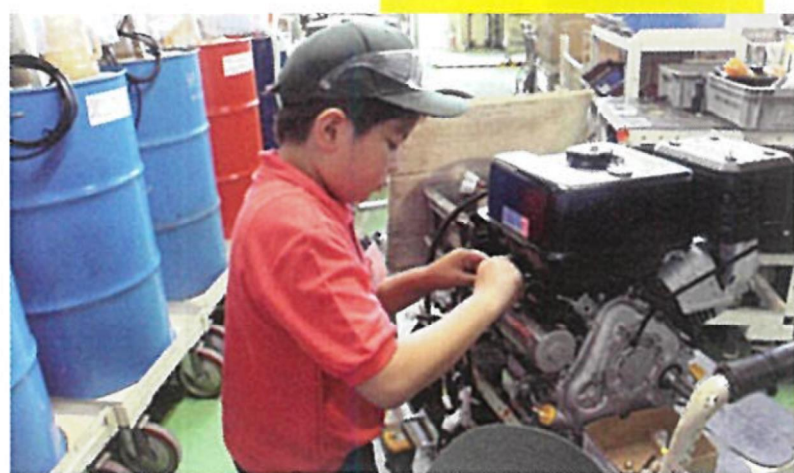
▲小型除雪機のエンジン部品の取り付け作業をする様子
