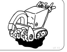
▲ 危険 燃料キャップをしめ、こぼれた燃料は拭き取る 燃料を補給したときは、燃料キャップを確実にしめ、こぼれた燃料はきれいに拭き取ってください。
