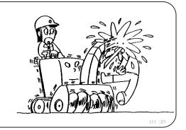
▲警告 エンジン始動時は走行・除雪クラッチを切る エンジンを始動するときは、走行・除雪のクラッチを切り、変速レバーは「N・中立」にしてください。
