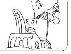
▲ 危険 燃料補給はエンジンを停止してから行なう 燃料補給は屋外で、エンジンを停止して十分に冷めたことを確認してから行なってください。
