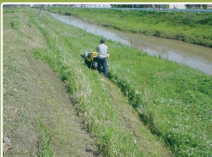
走行部はクローラを採用しているため、傾斜地での作業時にも高い走行性・安定性を発揮します。
