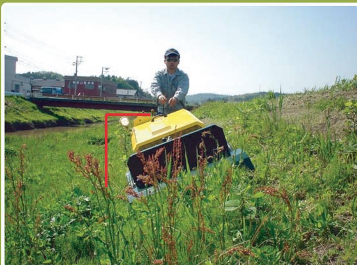
重心を低くした設計で、傾斜地でも安定した作業ができます。操作パネルは可動式のため、パネル部は水平で作業できます。
