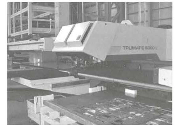
写真7 トルンプの2次元複合機 TC 6000 L
