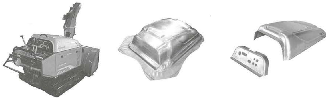
写真4 ドロミテ成形法による除雪機（左）のトップカバーとパネルの加工例。1つのプレス部品として加工（中央）したものを後工程の3 DLT加工で部品を切り出す（右）
