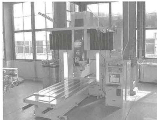
写真5 コマツ産機の3次元レーザー加工機 TLM 408
