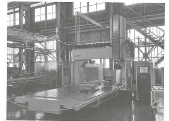
写真3 三菱電機の3次元レーザ加工機 ML 3122 V 20+40 CF-R
