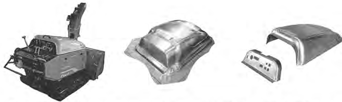
写真3 ドロミテ成形法による除雪機（右）のトップカバーとパネルの加工例。一つのプレス部品として加工（中央）したものを後工程の3次元レーザートリムで部品を切り出す（左）
