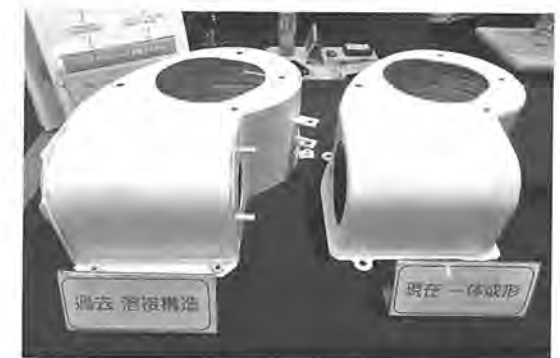
写真2 アクア成形による工法転換例。複数部品を溶接していた製品(左)を一体成形(右)に。金型数も8型から1型へと大幅削減
