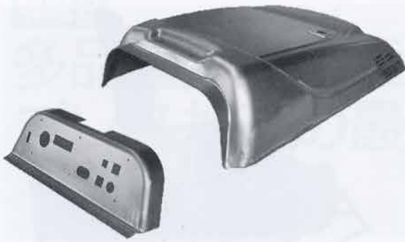
写真5 同時加工した部品 (左: 操作パネル、右: トップカバー)
