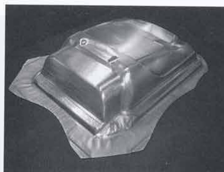
写真4 同時成形された時点での形状
